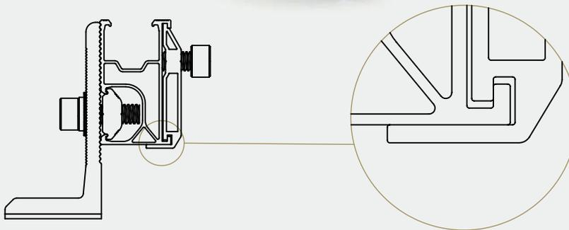
Soporte inferior adicional a dos rieles de unión proporciona seguridad y resistencia adicionales y aumenta significativamente la capacidad de compresión del riel.
