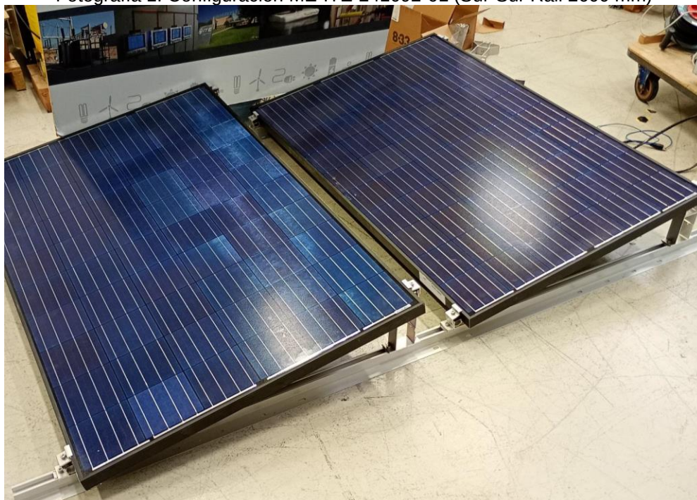
Fotografía 2: Configuración ME-ITE-241092-02 (Este-Oeste Rail 2600 mm)
